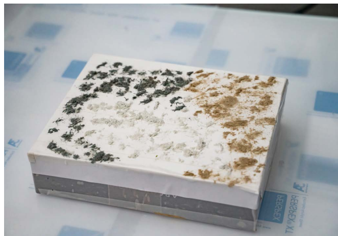
Neddelt plademateriale (frie asbestfibre) på dobbeltklæbende tape
